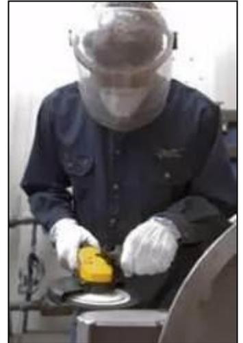
Otro aspecto importante es verificar el correcto funcionamiento de su equipo, para lo cual después de montar el disco, se debe comprobar el correcto ajuste del disco al esmeril angular, para lo cual se hace funcionar durante 1 minuto aproximadamente
