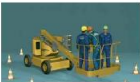
Figura 18. Plataforma de trabajo con exceso de personas
