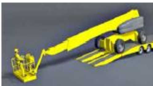
Figura 29. Colisión de la plataforma de trabajo contra el suelo.
