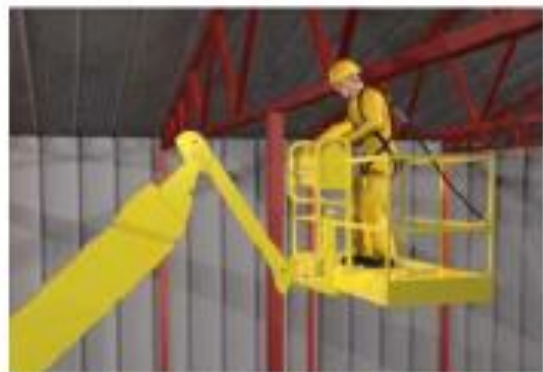
Figura 20. Atrapamiento contra objetos fijos en la fase de elevación de la plataforma
