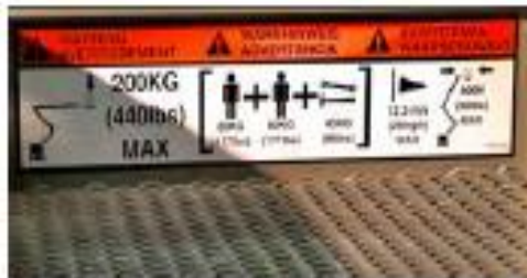
Figure 9. Señalización de carga nominal, número máximo de personas y equipo de trabajo, velocidad máxima del viento y punto de anclaje solo para retención.
