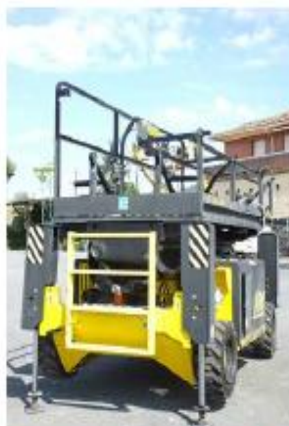
Figura 6. Plataformas de trabajo con protecciones perimetrales plegables.
