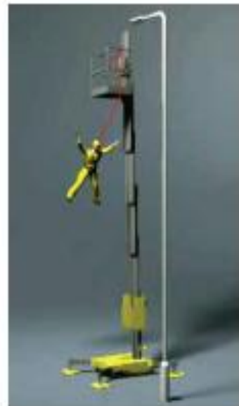
Figura 14. Caída con riesgo péndulo
