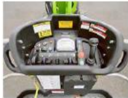
Figure 10. Mando primario sobre plataforma de trabajo.
