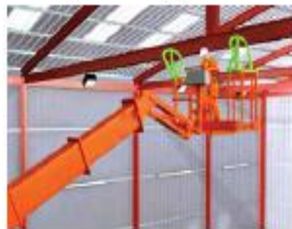
Figura 26. PEMP con sistema antiatrapamiento.
