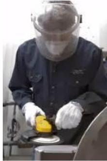
Cuando se trate de elegir el disco para el equipo, se deberán utilizar solamente accesorios diseñados especialmente para el tipo y modelo específico del equipo. El disco de corte, desbaste o pulido, debe estar de acuerdo con las revoluciones del Esmeril Angular y del material y características apropiadas para el tipo de trabajo a realizar.
