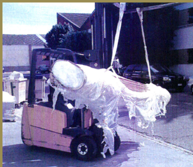
Las eslingas izquierdas están atadas y las derechas son dobles. Se observa el estado del mazo después de arrastrarlo.
