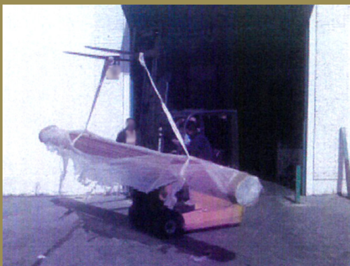
Operación de aproximar el mazo de tubos al camión. El lado derecho del paquete impactó con el operario.
