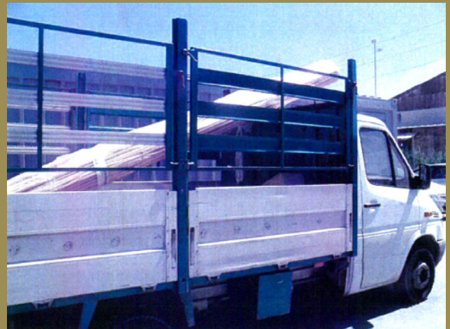
El primer mazo se cargó en el camión. El accidente ocurrió con el segundo. El camionero desde el remolque debía quitar primero la eslinga del lado apoyado sobre la cabina; después la del lado sobre el suelo de la caja.
