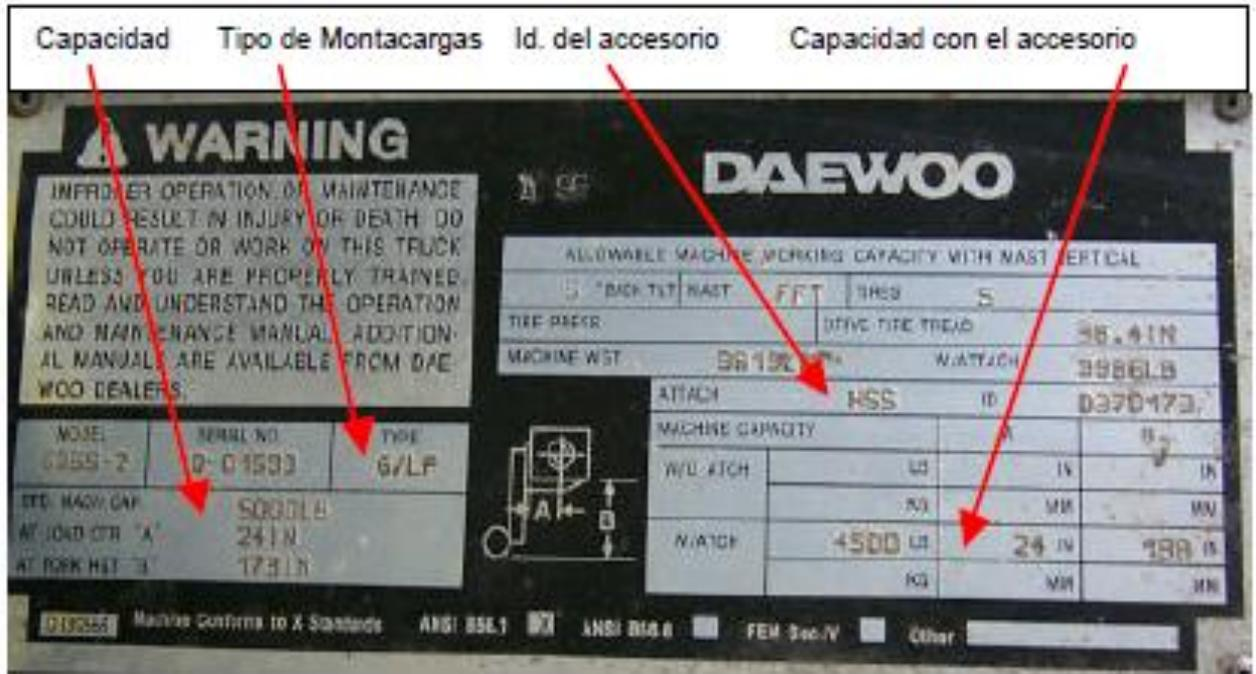
Este montacargas de gas propano puede levantar de manera segura 5,000 libras. 173' pies de altura con un centro de gravedad de 24" desde el frente de las horquillas. Con un accesorio etiquetado "HSS", la carga de seguridad baja hasta las 4,500 libras.
