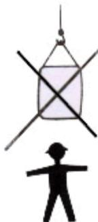
La apertura de la válvula de descargue ubicada en el fondo del saco sólo debe efectuarse cuando el Big Bag esté soportado debidamente en una plataforma de seguridad, previniendo heridas al operador en el evento de una falla en el dispositivo de levantamiento.
