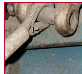
Eslinga con guardacabos
