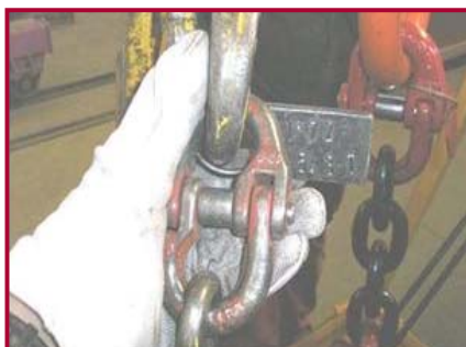
Conector de una eslinga cadena
