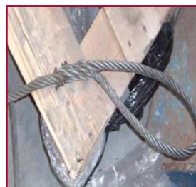
Eslinga de cable con ojal trenzado
