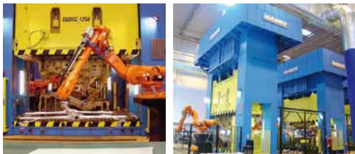
Figura 15. Prensas con robot (Fuentes: Loiresafe).
