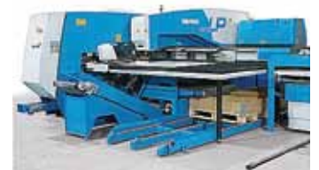
Figura 1. Máquina que integra cizalla y punzonadora (Fuente: Finnpower).
