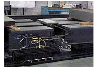
Figura 9. Sistema de elevación y nivelación (Fuente: Danobat).
