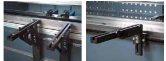
Figura 4. Soportes frontales (Fuente: DURMA).
