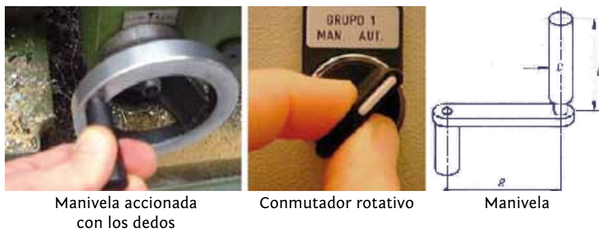
Figura 14. Principales mandos y empuñaduras en tornos (Fuente: IBV).
