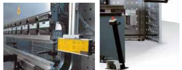
Figura 6. Plegadora con varios sistemas de seguridad (Fuente: Durma).
