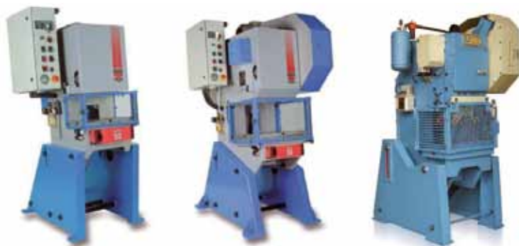
Figura 3. Prensas con bastidor inclinable (Fuentes: EMGpresses, Esna).
