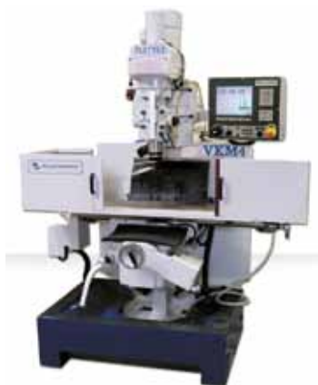
Figura 2. Fresadoras con espacio previsto para los pies (Fuente: Milltronics).
