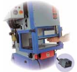
Figura 4. Pantalla vertical automática (Fuente: EMGpresses).
