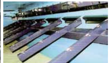
Figura 6. Soporte para chapas finas (Fuentes: Durma, Feysama).
