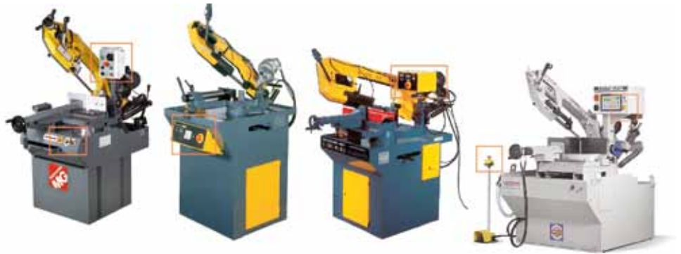
Figura 17. Diferentes localizaciones de la parada de emergencia (Fuentes: MG, Thomas).
