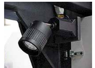
Figura 18. Lámpara de posicionado (Fuente: Danobat).
