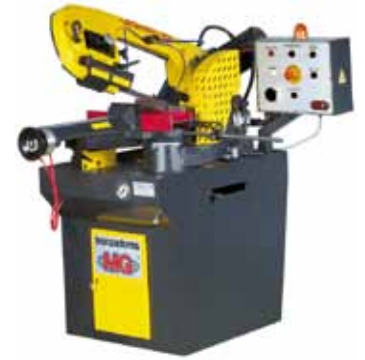
Figura 16. Tronzadora con dispositivo visual y sonoro (Fuente: MG).
