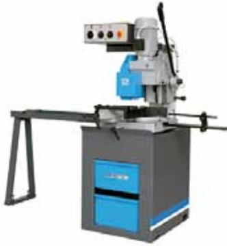
Figura 6. Tronzadora de disco con banco de apoyo (Fuente: Macc).
