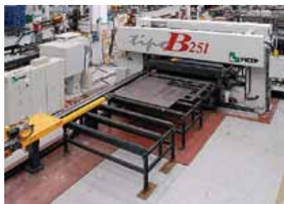
Figura 2. Cizalla, punzonadora y taladro CNC (Fuente: FICEP).
