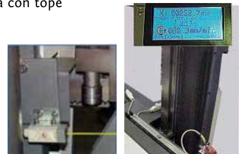
Figura 10. Ayudas relacionadas con el desplazamiento del cabezal (Fuente: Danobat).
