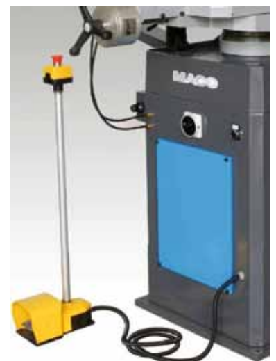
Figura 10. Pedal de accionamiento (Fuente: Macc).
