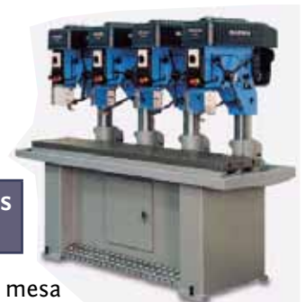
Figura 15. Taladros en batería (Fuente: Ibarria).
