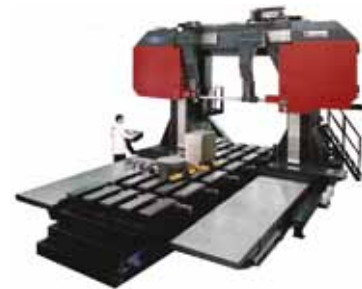
Figura 12. Sierra tronzadora tipo pórtico para grandes formatos (Fuente: Danobat).
