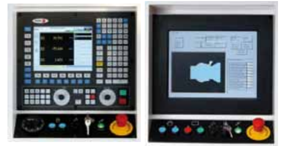
Figura 16. Control numérico con diferentes pantallas (Fuente: Unamuno).
