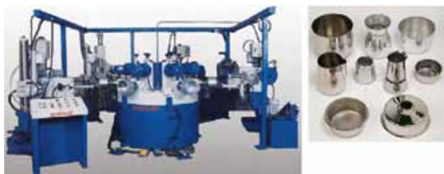
Figura 13. Lijadora para ollas y cacerolas (Fuente: Autopulit).
