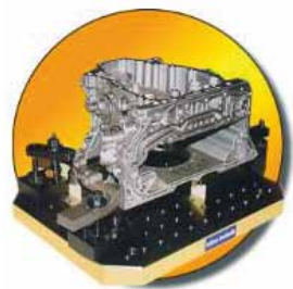
Figura 10. Sistema de utillaje modular (Fuente: Bluco).
