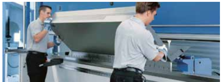
Figura 11. Plegado de piezas grandes (Fuente: Trumpf).
