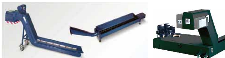
Figura 17. Sistemas de extracción de virutas (Fuentes: Famasa, Kondia).
