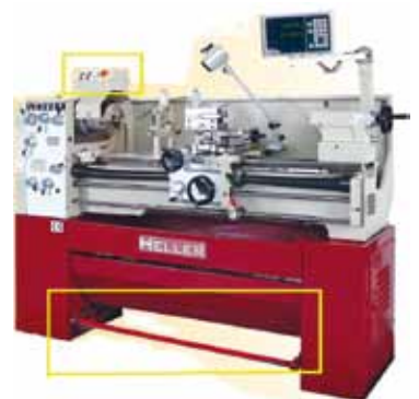
Figura 19. Torno con parada y freno de emergencia (Fuente: Heller).
