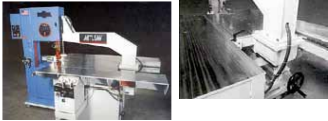
Figura 11. Sierra para piezas circulares con ajuste de mesa (Fuente: Metl Saw).
