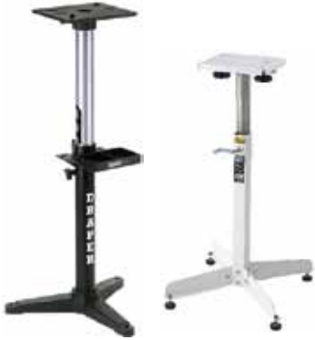
Figura 2. Pedestal para amoladoras regulable en altura (Fuentes: Draper, HTC).
