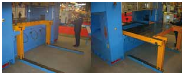
Figura 9. Sistemas para la introducción rápida del troquel (Fuente: Arisa).
