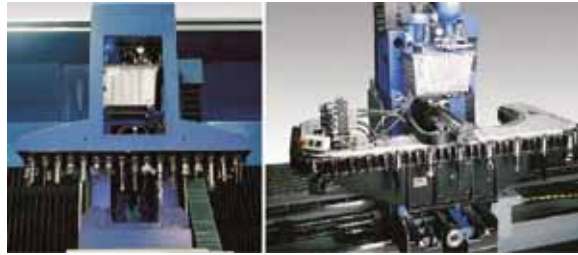
Figura 8. Almacenes automáticos de herramientas (Fuente: Ibarria).
