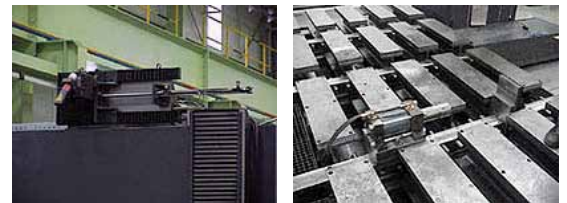
Figura 8. Línea láser móvil y mordaza hidráulica con tope (Fuente: Danobat).
