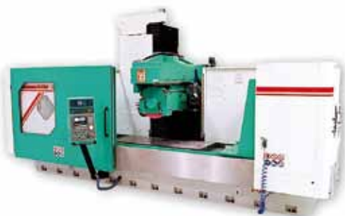
Figura 2. Rectificadora con puerta frontal y ventanas (Fuente: Rosa Ermando).
