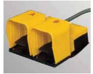
Figura 6. Pedales de accionamiento de la soldadora (Fuente CEA).
