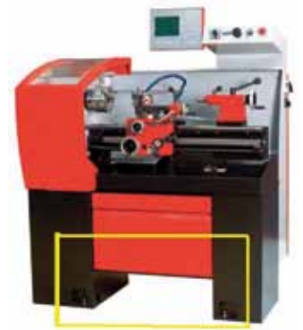
Figura 2. Torno con espacio para los pies (Fuente: Emco).
