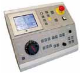
Figura 9. Panel de control con pantalla táctil (Fuente: Jones & Shipman).
