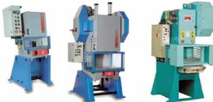
Figura 2. Prensas con espacio para las piernas (Fuentes: IMS, EMGpresses).
