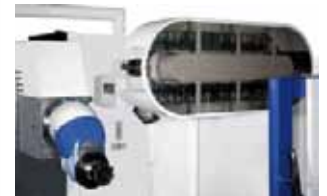
Figura 10. Almacenes automáticos para herramientas (Fuentes: MTE, Soraluce).
