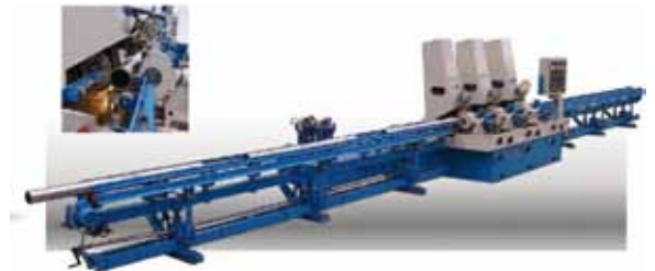
Figura 3. Lijadora para tubos y barras redondas (Fuente: Autopulit).
