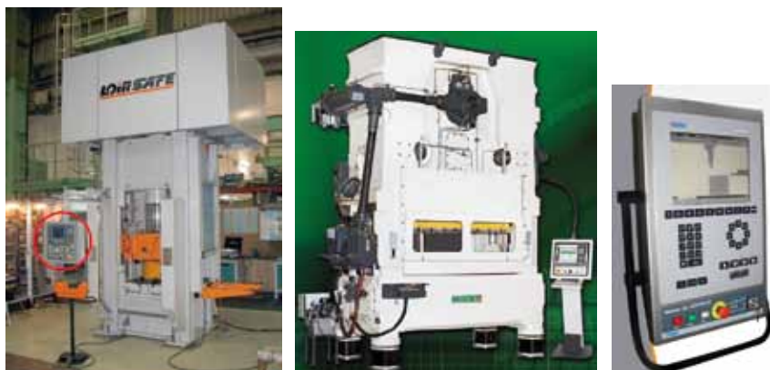
Figura 16. Panel de mandos (Fuentes: Loiresafe, Bruderer, Ermak).
