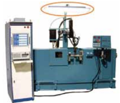
Figura 7. Soldadora con iluminación localizada (Fuente: Jetline).
