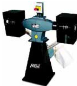
Figura 5. Amoladoras dotadas de parada de emergencia (Fuentes: Femi, Grizzly).
