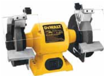
Figura 3. Amoladora con apoyos (Fuente: DeWalt, Ryobi).
