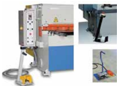
Figura 3. Pedales de seguridad para controlar los ciclos (Fuentes: Ermaksan, Durma, Femas).
