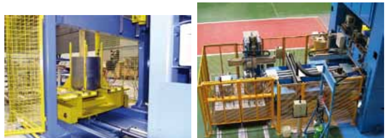
Figura 7. Sistemas de alimentación de formatos (Fuente: Arisa).
