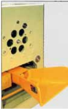
Figura 10. Extractor de virutas (Fuentes: Mupem y Pinacho).
