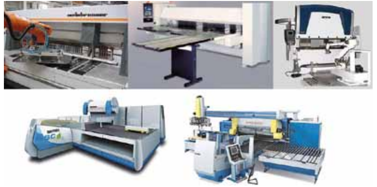
Figura 10. Plegadoras automáticas y semi-automáticas (Fuentes: Schmalz, Adira, Ras, Finnpower).
