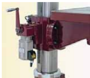
Figura 3. Mesa motorizada (Fuentes: Heller, Knuth).
