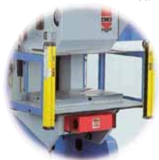
Figura 17. Barrera de seguridad (Fuente: EMGpresses).
