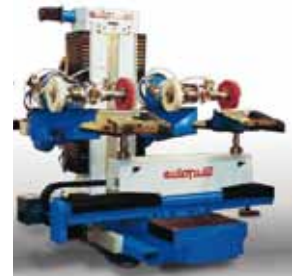
Figura 7. Pulidora CNC para el acabado de dos piezas simultáneamente (Fuente: Autopulit).
