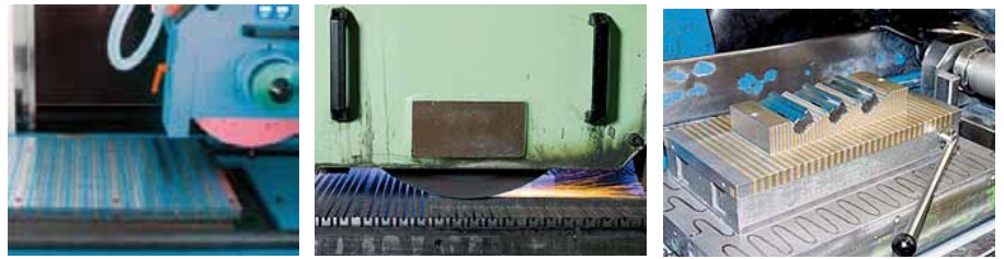
Figura 5. Placas magnéticas (Fuente: Schunk).
