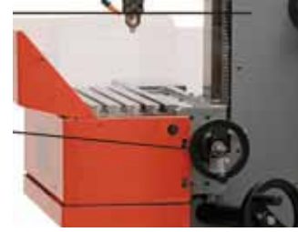
Figura 15. Ranura en forma de T (Fuente: EMCO).
