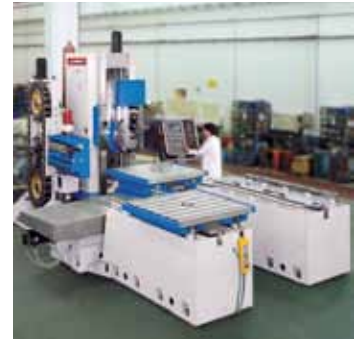
Figura 8. Fresadoras con sistemas de paletización (Fuentes: CME, Juaristi).
