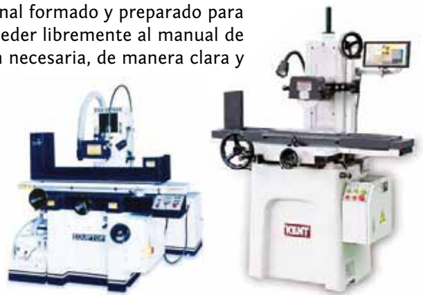
Figura 11. Rectificadoras con iluminación local (Fuentes: Equiptop, Kent).
