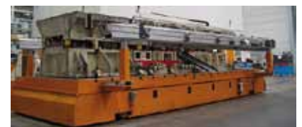
Figura 12. Centrado rápido del troquel (Fuente: Arisa).
