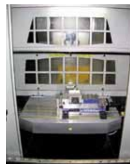
Figura 5. Detalle de la mesa pendular (Fuente: Ibarria).
