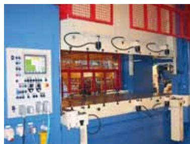
Figura 13. Sujeción rápida del troquel (Fuente: Arisa).
