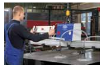
Figura 8. Sistema de ayuda para la alimentación (Fuentes: Yeh Chiun, Schmalz).
