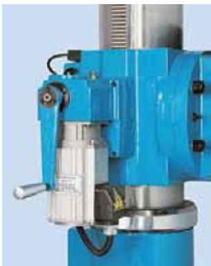
Figura 3. Mesa motorizada (Fuentes: Heller, Knuth).
