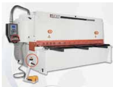
Figura 10. Cizalla con diversas paradas de emergencia (Fuente: Ermaksan).
