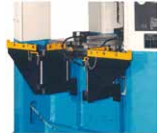
Figura 10. Brazos de carga de herramientas (Fuente: Bliss).
