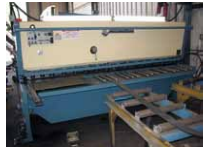
Figura 12. Accesorios de conducción, patín y rodillos (Fuente: Promecam).
