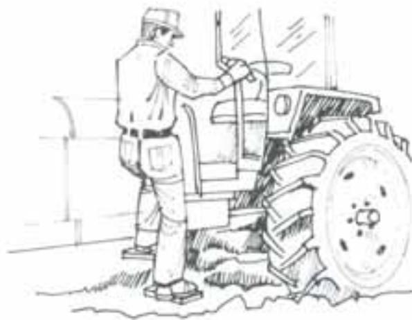
Conducir el tractor exclusivamente desde la plataforma del operador y en posición sentada.
