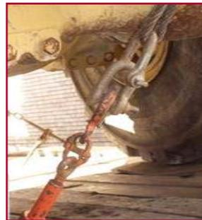
*Ejemplos fotográficos de grilletes y sistema de sujeción inadecuados para la inmovilización de maquinaria durante su transporte en vehículos especiales.*
