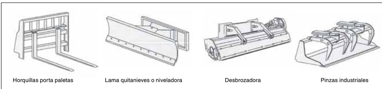
Figura 6. Equipos intercambiables
