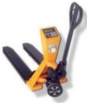
La transpaleta manual **es una carretilla de pequeño recorrido de elevación, trasladable a brazo**, equipada con una horquilla formada por dos brazos paralelos horizontales unidos sólidamente a un cabezal vertical provisto de ruedas en **tres puntos de apoyo sobre el suelo y que puede levantar y transportar paletas o recipientes** especialmente concebidos para este uso.
