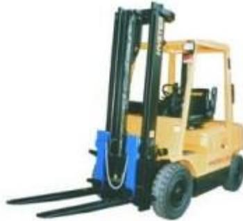
Se asienta sobre dos ejes: **motriz, el delantero y directriz, el trasero**. Pueden ser eléctricas o con motor de combustión interna. **Nunca se deben utilizar para el transporte de personas** y debe ser siempre **utilizada por personal debidamente formado**, incluso ya existen cursos específicos para formar a los operarios en su uso.
