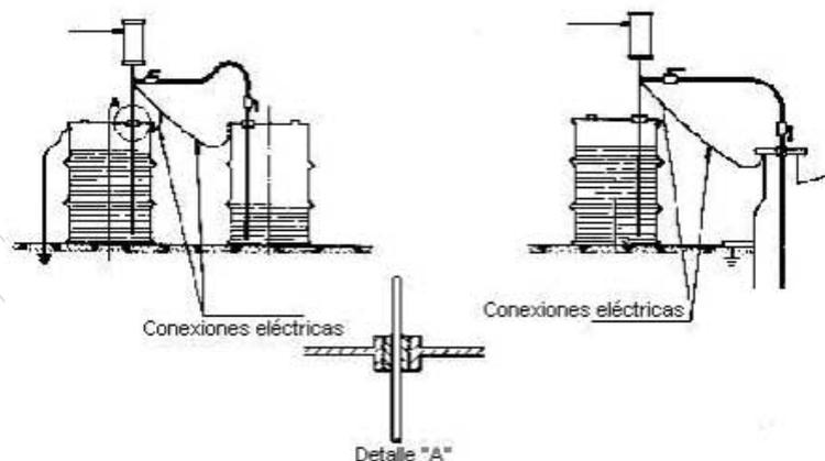
Fig. 7: Transvase mediante bombas portátiles. Sujeción solidaria a los recipientes de los tubos de aspiración y de los tubos de carga
