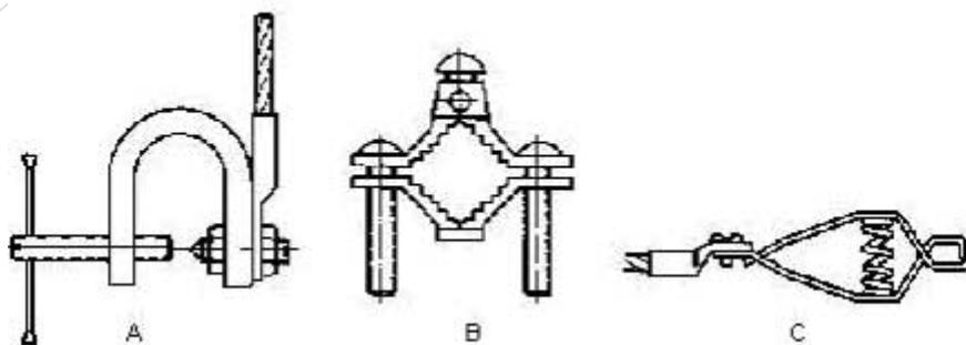
**Fig. 3: Sistemas de sujeción de las tomas a tierra a los cuerpos metálicos de recipientes y tuberías:**
