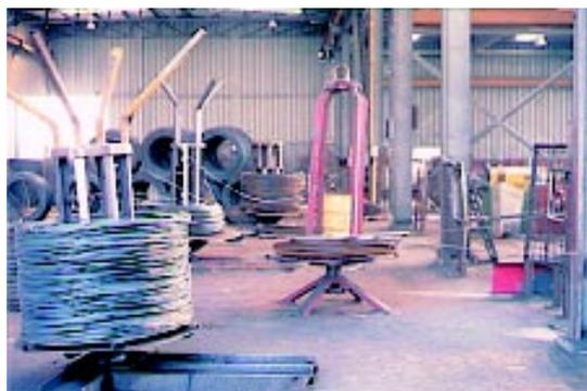
Cuando el devanador esté a 1,5 metros de la máquina, como máximo, se instalará una protección frontal; para distancias mayores además se colocarán protecciones laterales a ambos costados.
