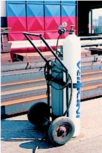
El carro tiene una base que permite colocarlo en posición vertical, los cilindros van asegurados con cadenas para evitar su caída.
