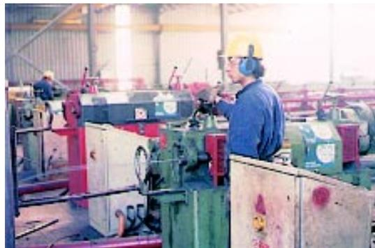
No se debe meter las manos a partes en movimiento. Si se necesita intervenir en un punto peligroso, se pulsará el botón de parada, luego se debe bloquear el control o señalizarlo y cuando la máquina se haya detenido efectivamente se podrá efectuar la acción prevista.
