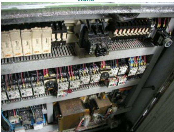
Cuadro de centro de mecanizado con viruta metálica en su interior
