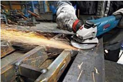
Esmerilar se constituye como un trabajo de alto riesgo por ser un trabajo en caliente, para el cual hay que tener el suficiente conocimiento del equipo, ya se trate de un esmeril fijo o uno de mano. Los esmeriles trabajan con el propósito de desbastar la pieza que se encuentran esmerilando
