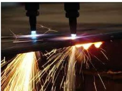
Básicamente los trabajos de oxicorte consiste en un equipo de trabajo que consiste en un sistema de soldadura y corte donde como característica principal resalta el uso de un soplete y dos tipos de gases como son el acetileno y el oxígeno, ambos en estado comprimido.
