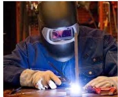
Por la naturaleza de esta actividad, la soldadura tiende a producir cierto tipo humos contaminantes y ruido, incluso emite cierto tipo de radiación, y además hace uso de electricidad o gases, que involucra cierto riesgo de electrocución, pudiendo provocar asimismo quemaduras, descargas eléctricas, explosiones e incluso incendios.
