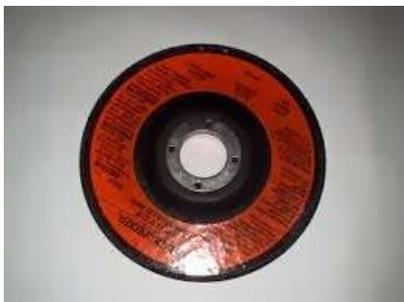
Otro aspecto importante es verificar el correcto funcionamiento de su equipo, para lo cual después de montar el disco, se debe comprobar el correcto ajuste del disco al esmeril angular, para lo cual se hace funcionar durante 1 minuto aproximadamente el equipo, luego se inspecciona si el disco presenta trizaduras, mal ajuste al eje, o quizá alguna fricción con el casquete protector del equipo. Se debe además evitar apretar los discos de desbaste con
