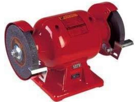
el principio de su trabajo se da por la rotación del disco abrasivo, para trabajar sobre perfiles estructurales, cerámicos, hormigón, etc.
