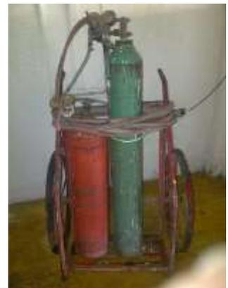
• Luego de un incendio de la válvula de un balón de acetileno, debe verificarse que este no se calienta solo, y de ser así se debe intentar bajar la temperatura con agua o cualquier otro elemento refrigerante.
