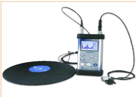
Imagen 4. Vibrómetro con acelerómetro uniaxial, para mediciones de vibraciones en mano-brazo
