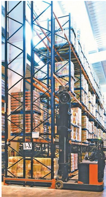
Imagen de un autoelevador retráctil de doble fondo utilizada en un depósito de productos alimentarios de gran consumo.
