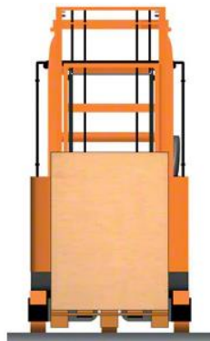
Autoelevador retráctil con el pallet dentro del chasis
