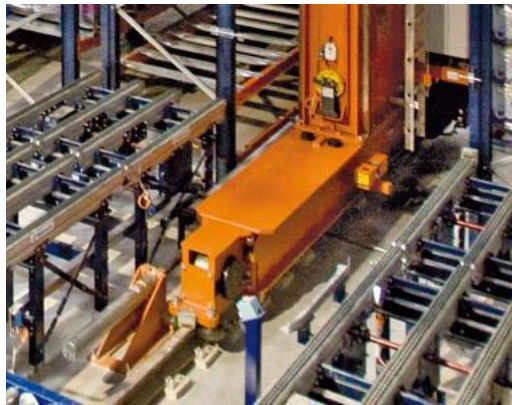
Detalle de un testero o bastidor inferior de un transelevador y de un carril de rodadura.
