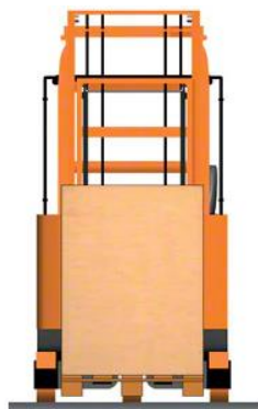
Autoelevador retráctil con el pallet dentro del chasis
