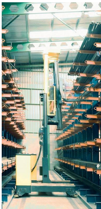
Imagen de un autoelevador retráctil de doble fondo utilizada en un depósito de productos alimentarios de gran consumo.
