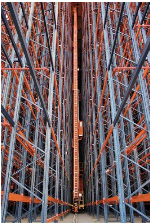
Testero superior de un transelevador y carril superior
