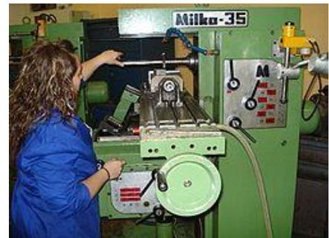
Una vez que la fresadora ha sido preparada para un trabajo determinado, el control posterior del trabajo de la máquina suele encargarse a una persona de menor preparación técnica que sólo debe ocuparse de que la calidad de las piezas mecanizadas se vaya cumpliendo dentro de las calidades de tolerancia y rugosidad exigidas. A veces un operario es capaz de atender a varias fresadoras, si éstas tienen automatizados el sistema de alimentación de piezas mediante autómatas programables.
