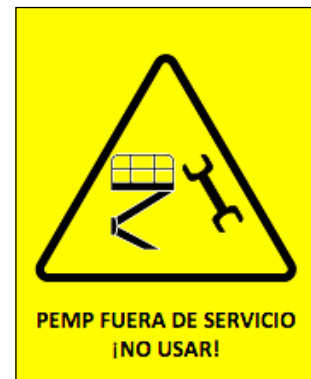
Figura 24. Señal de PEMP fuera de servicio.
