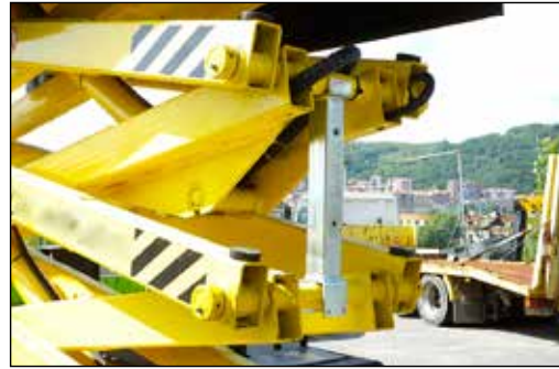
Figura 16. Sistema mecánico de seguridad. Detalle.
