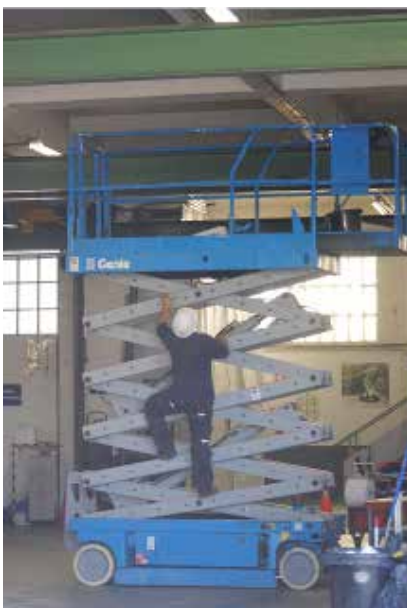
Figura 11. Subir/bajar, a/desde la plataforma de trabajo por la estructura extensible
