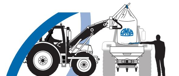
**Figura 5.** Colóquese a un lado del big bag y use un cuchillo con mango largo para abrir el big bag.
