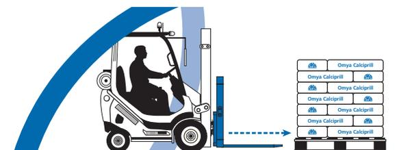
**Figura 4.** Mantenga la horquilla en posición horizontal en todo momento.
