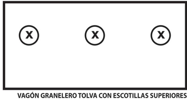
En vagonetas tolva o carrilines (Fig. 2.5), se debe realizar una calada en el centro con calador y completar la muestra con cucharín a medida que se descarga.
