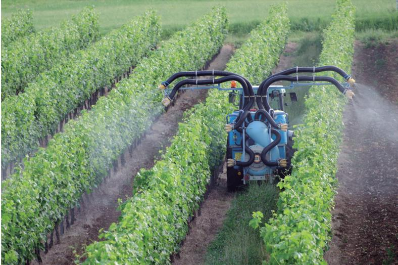
Figura 10. Equipo de aplicación neumática
