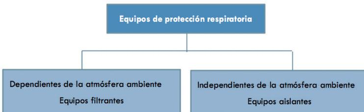
Figura 20. Clasificación en función del sistema de aporte de gas respirable
