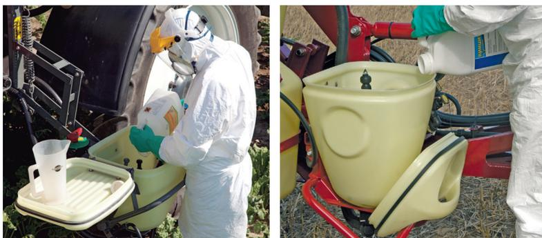
Figura 16. Sistema incorporador de producto fitosanitario (Fuente: Hardi)
