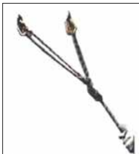
Figura 15. Triángulo realizado mediante ocho de doble seno.
