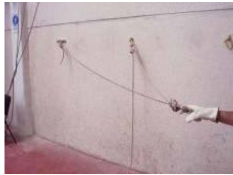
Figura 16. Sistema realizado mediante tres ochos.
