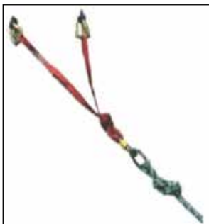
Figura 14. Triángulo bloqueado con una eslinga.
