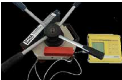
Figura 3. Máquina medidora de resistencias.
