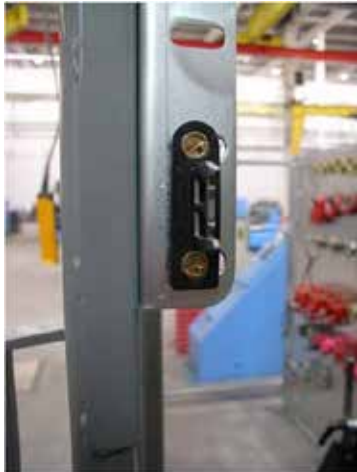
Figura 14. Fijación del actuador mediante tornillos de sentido único.
