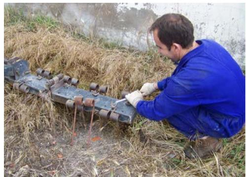
Sustitución de pieza de un cultivador.
