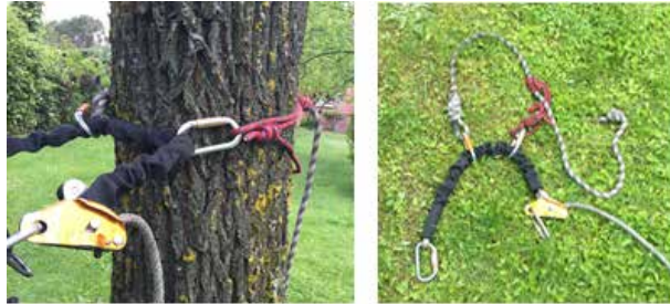
Figura 12. Fijación de la eslinga con un sistema regulable.
