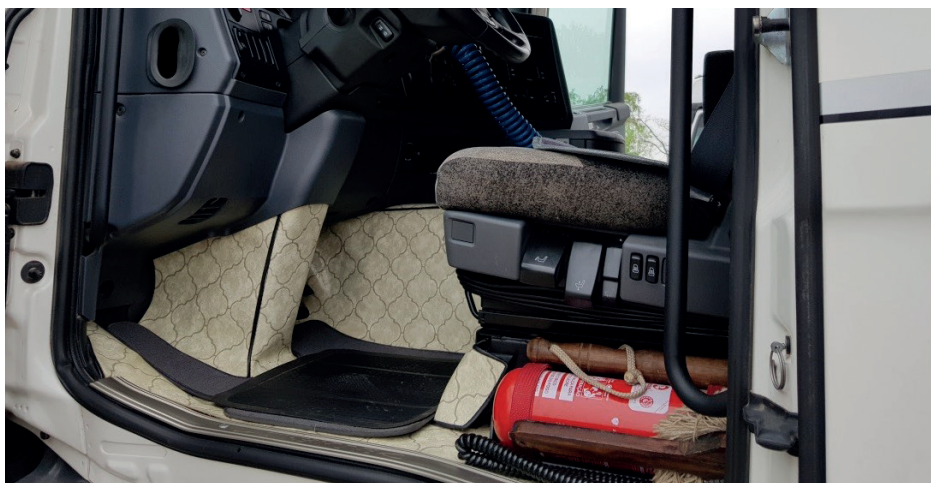
Extintor de incendio debe estar ubicado dentro de la cabina, en un lugar de fácil acceso y sujetado.
