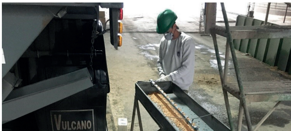
Vista de un calador manual utilizado en la toma de muestra.
