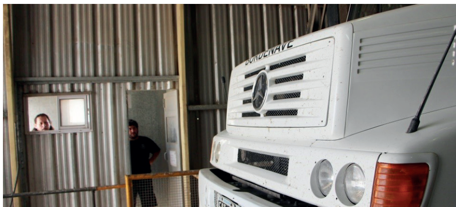
Posicionamiento seguro de los trabajadores durante las tareas de descarga del camión.
