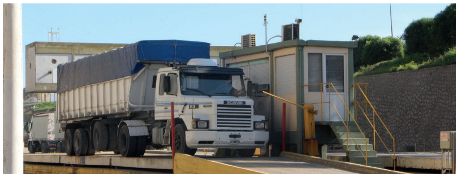
Pesaje del camión en balanza de la terminal portuaria.
