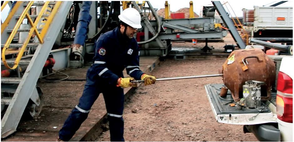
Maniobra correcta de manipulación de una fuente de neutrones con telepinya, previo a su traslado hacia el bunker de la base de operaciones.
