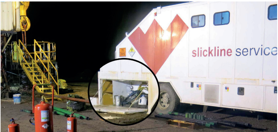
Vista ampliada de la parte trasera derecha de un camión de servicios de trazado y perfilaje, con la caja transportadora de porta fuente, herramientas y elementos de protección personal para la manipulación de fuentes radiactivas.
