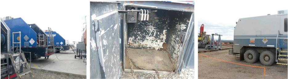
Imagen 1: Camiones especiales para operaciones especiales con RI. Imagen 2: Baúl específico para traslado de material radiactivo. Imagen 3: Zona demarcada indicadora de presencia de RI durante la maniobra.
