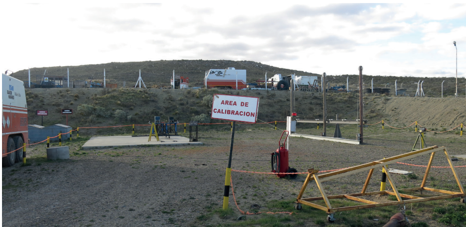
Demarcación y señalización de zona dedicada a la calibración de fuentes selladas, en el marco de la locación. Cuenta con dosimetría de área.
