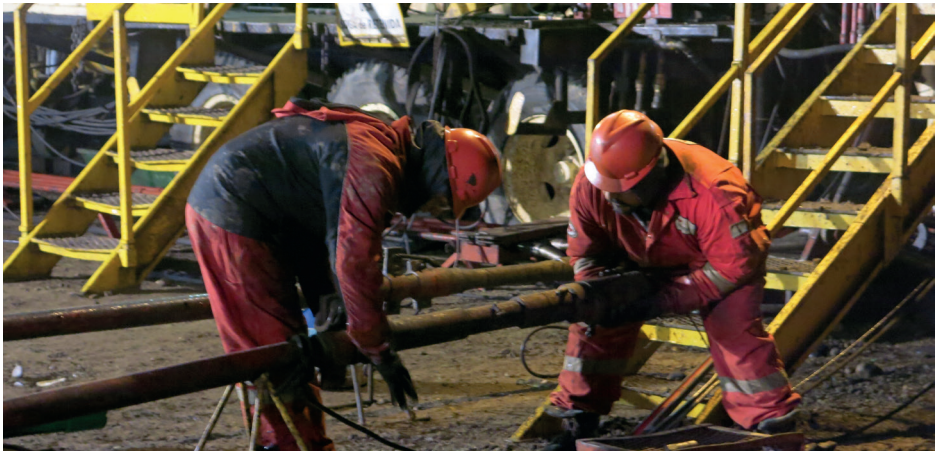
Armado conjunto de la herramienta de perfilaje, previo a la colocación de la fuente.
