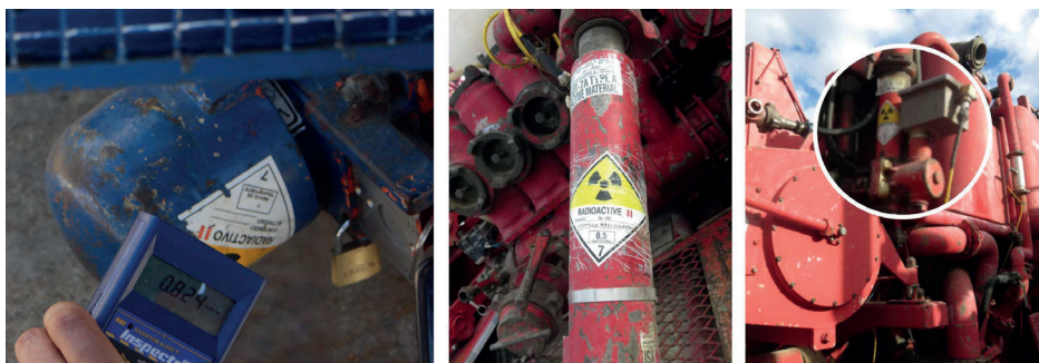
Dos tipos de densímetros alojados en camiones de cementación y capaces de emitir radiaciones gamma.
