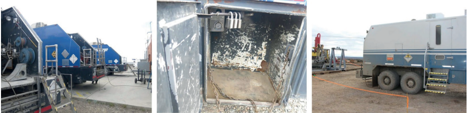
1. imagen de la parte posterior del camión 2. Baúl para transporte de fuentes radiactivas en la parte posterolateral del camión 3. Zona radiocontrolada definida y señalizada en la locación.
