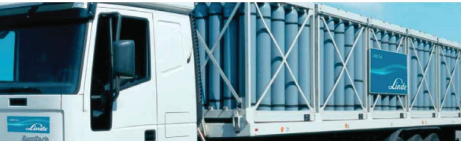
Los cilindros de gases comprimidos más usuales contienen acetileno, oxígeno anhídrido carbónico (dióxido de carbono) y además Gas Licuado de Petróleo (GLP) cuyos cilindros más pequeños los llamamos garrafas. Otros gases comprimidos en cilindros son cloro, nitrógeno, hidrógeno, argón, etc. Todos ellos son mercancía peligrosa Clase 2 Gases. Para poder transportarlo el gas debe estar comprimido.
