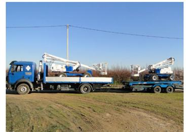
Este tipo de plataformas elevadoras deberán ser transportadas en un camión, en su posición plegada de transporte, tal y como indique el fabricante, y debidamente sujeta con eslingas.
