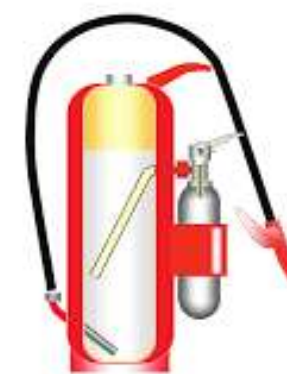
EXTINTOR DE PRESIÓN ADOSADA (BOTELLÍN EXTERIOR)
