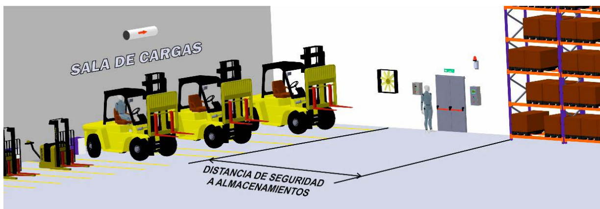
Figura 12. Distancia de seguridad en sala de carga de vehículos de mantenimiento y limpieza. (Fuente: EPITÉCNICA)
