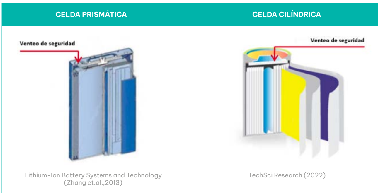
Figura 3. VENTEO DE SEGURIDAD EN DIFERENTES TIPOS DE CELDA.
