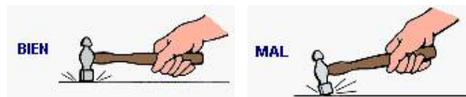
Fig. 7: Forma de golpear sobre una superficie
