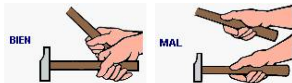
Fig. 6: Forma de sujeción del mango
