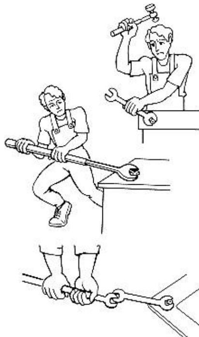
Fig. 8: Utilización de llaves inadecuadas
