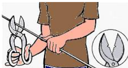
Fig. 15 Utilización incorrecta de tijeras con hojas melladas
