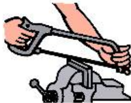
Fig. 13: Pieza fijada firmemente antes de serrar
