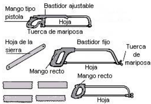
Fig. 12: Partes y tipos de sierras de arco
