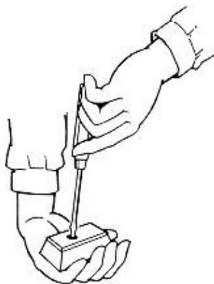
Fig. 14: Sujeción incorrecta de una pieza a atornillar
